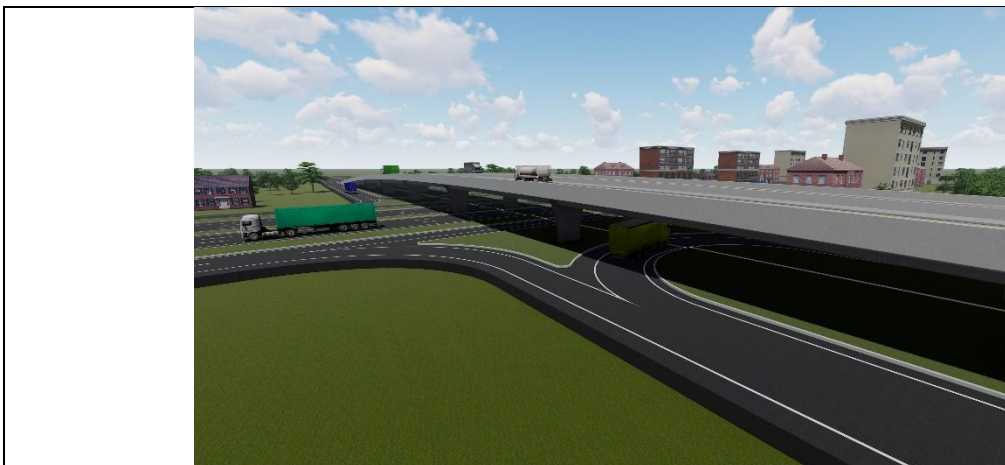
รูปที่ 7-3 ตัวอย่างรูปแบบจุดกลับรถได้สะพาน แบบทิศทางเดียว
