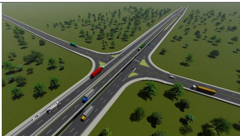
รูปที่ 6-6 ตัวอย่างรูปแบบถนนบริเวณจุดตัดทางแยกในอนาคต (ทางแยกต่างระดับ)
